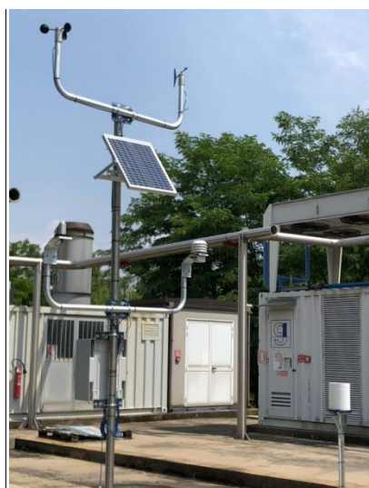
PF3-55 - Palo telescopico h=3m con piastra per fissaggio su platea in cls
