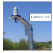
piano del piranometro, per non introdurre errori di misura causati dai riflessi ed ombre provocate dal palo. E' preferibile isolare termicamente il piranometro dal suo supporto, al tempo stesso assicurarsi che ci sia un buon contatto elettrico verso massa. NOTA: il sensore viene fornito completo di staffa universale STF-UNI per il montaggio su pali orizzontali o verticali ø25...43mm
