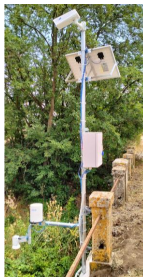
Esempi di installazione con pali da 3m (con web-cam, pluviometro e lampada di segnalazione di pericolo)
