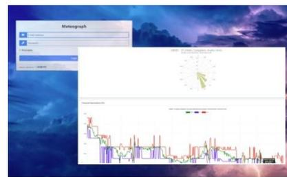
**METEOGRAPH** è un applicativo web per la visualizzazione numerica e grafica dei dati trasmessi via GPRS su area FTP da stazioni di monitoraggio ambientale con datalogger Geoves.
